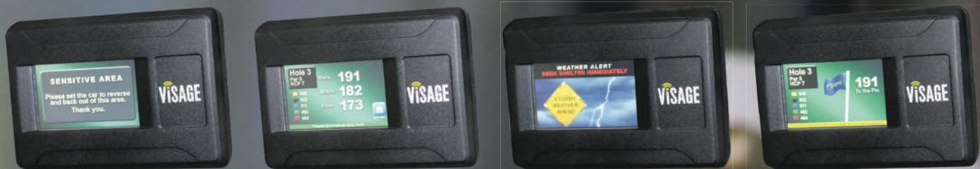
L'écran de Visage LT, installé sur la voiturette, est plus petit ; il permet d'afficher des messages, des diagnostics et de nombreuses fonctionnalités d'expérience de golfeur. Le système basé sur le cloud est accessible à l'aide d'un périphérique équipé d'Internet.
